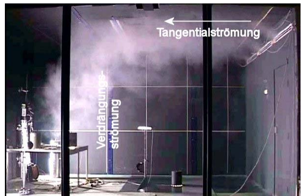
Prinzip Tangentialströmung mit anschließender Misch-/Verdrängungsströmung
