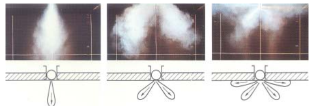
Beispiele verschiedener Strömungsformen
